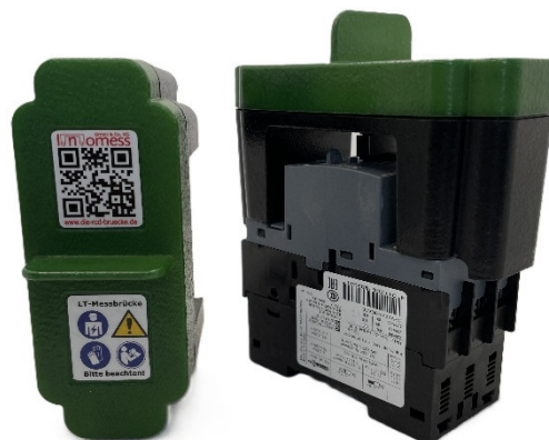
Bild 2: richtige Positionierung der LastLink-Messbrücke
